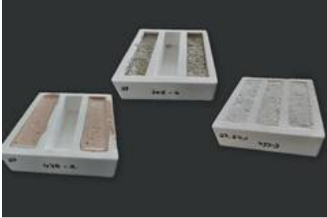
Der Rohdichtebereich des Mineralschaums von Bautark reicht von 30 bis 300 kg/m 3 . Bild: tdx/Bautark
